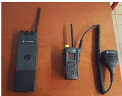
Vergleich der Technik: links altes Analogfunkgerät, rechts Digitalfunkgerät
