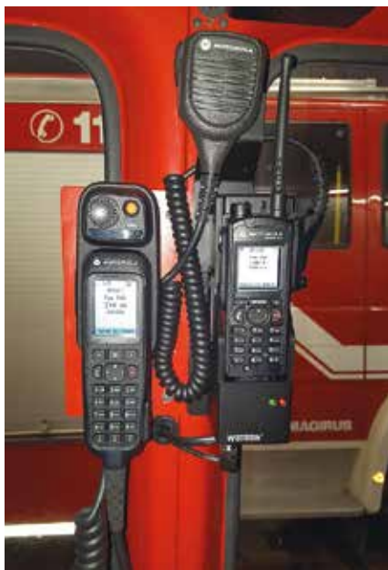
Digitalfunkgeräte am Einsatzleitplatz im MZF der FF Markt, links Fahrzeugfunkgerät (MRT), rechts Handfunkgerät (HRT)
